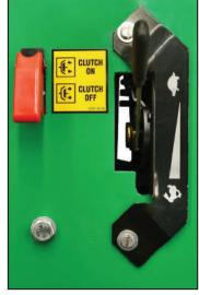
THROTTLE LEVER CONTROL CLUTCH ON/OFF SWITCH
